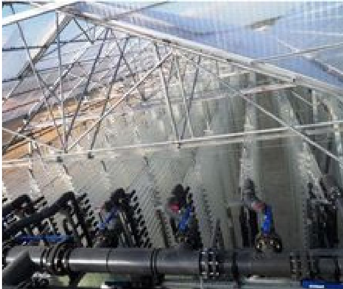
IGV a implanté sur le site de Jerez en Andalousie avec l'entreprise Aurantia, un démonstrateur de 1000 m 2 fonctionnant avec un PBR tubulaire de 85000 litres comprenant 35 km de tubes en verre © MANQUE LE CREDIT
